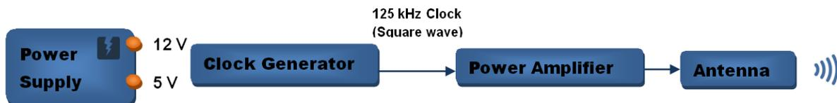
FIGURE 2 THE TRANSMITTER BLOCK DIAGRAM
