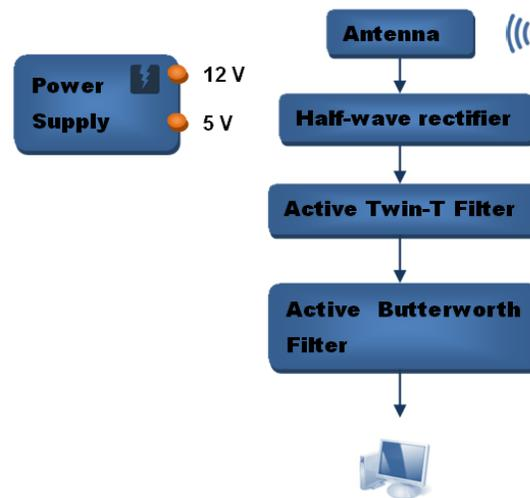
FIGURE 7 BLOCK DIAGRAM OF THE RECEIVER
